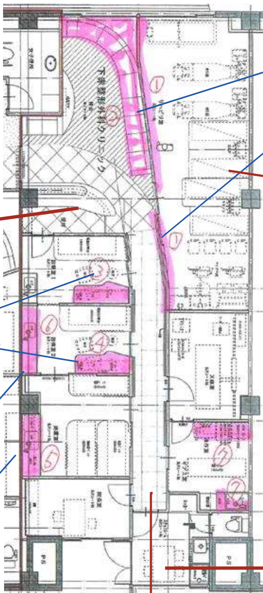
③④ 診察室1と診察室2の壁面据付テーブル撤去
